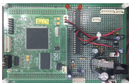
Fig. 9 Controller using DSP320F2812
